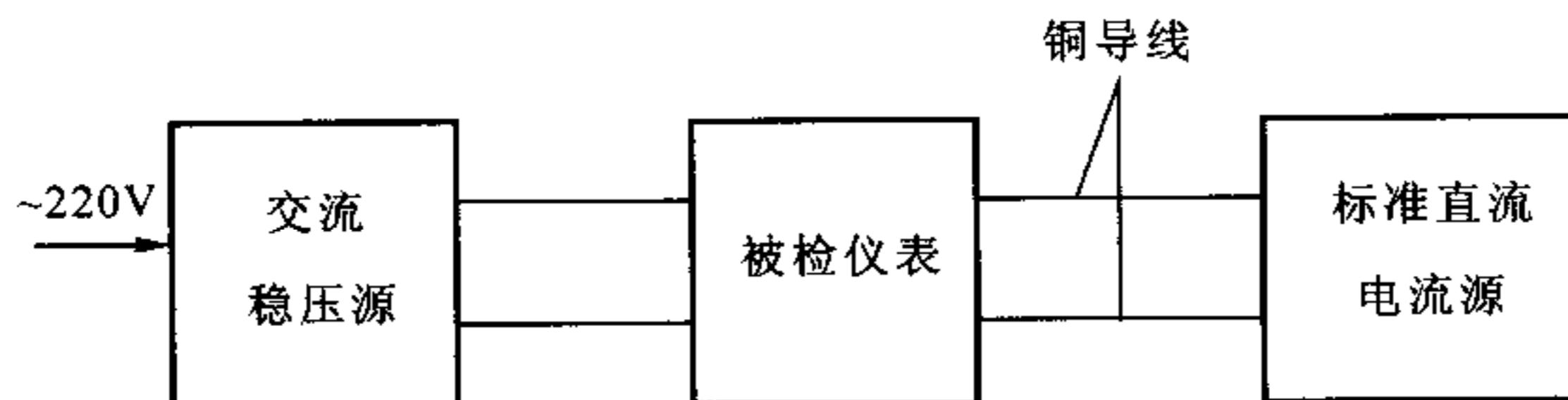
图 5 输入信号为直流电流仪表的检定接线示意
